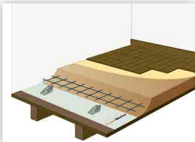
Impermeabilizzazione soletta collaborante in Calcestruzzo CentroStorico
